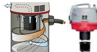
Запатентованная система сепарации воды с устройством «Циклон». Арт. № 109.057
