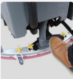
Задняя балка и дисковая щётка опускаются и поднимаются при помощи ноги
